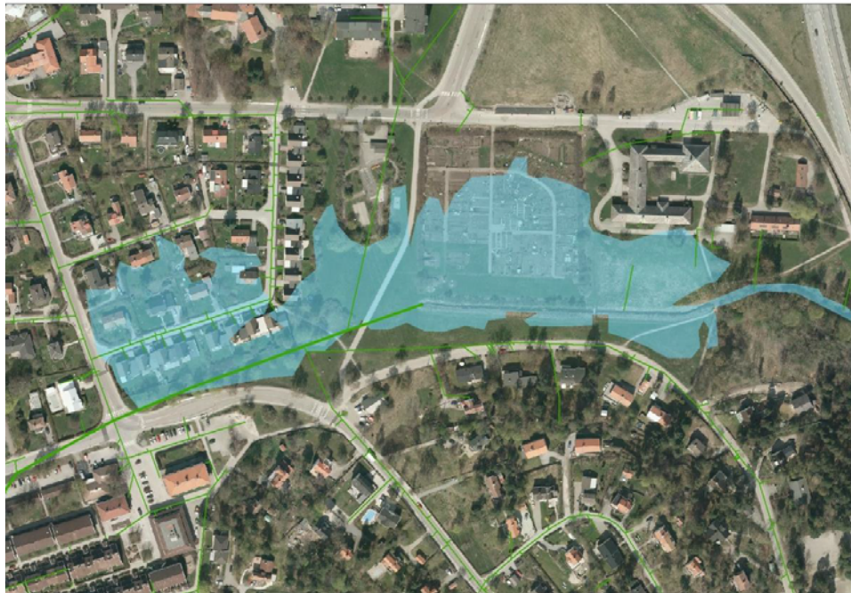
Översvänningsutbredning vid blockerad kulvert och 100-årsregn.
